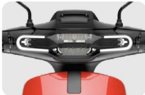
SUPER SOCO Faro superiore LED nascosto. Layout matrix che caratterizza il frontale.
