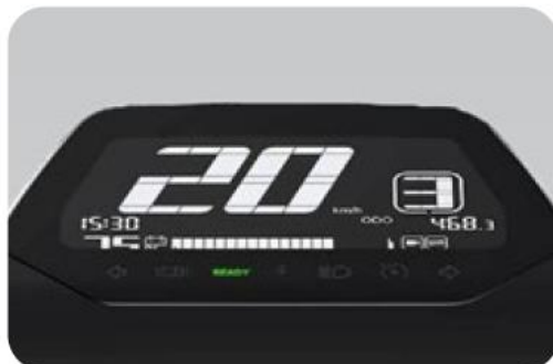
Display LCD con regolazione automatica della luminosità.
