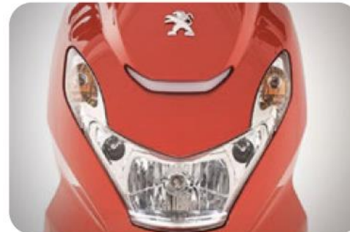
La maggior parte degli scooter termici sono equipaggiati con faro anteriore alogeno e frecce senza DRL
