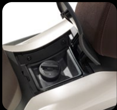
TAPPO SERBATOIO POSIZIONATO NEL TUNNEL
